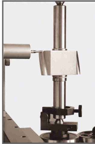
Измерение эталона угла наклона линии зуба
