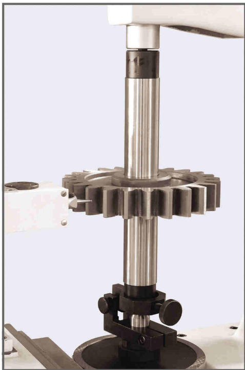
Измерение прямозубой цилиндрической шестерни
