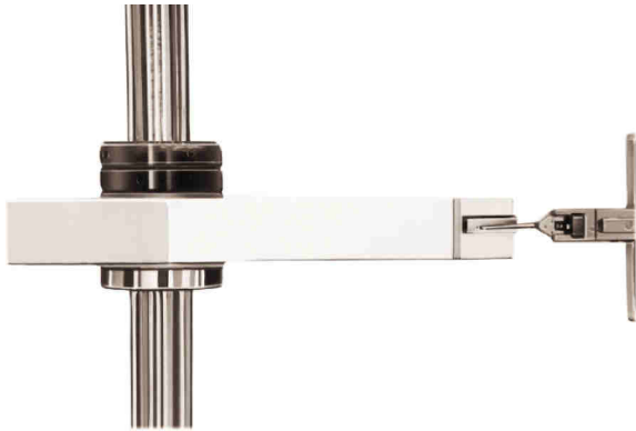
Контроль эталона эвольвенты
