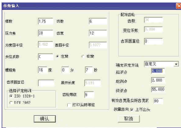
Окно ввода параметров шестерни
