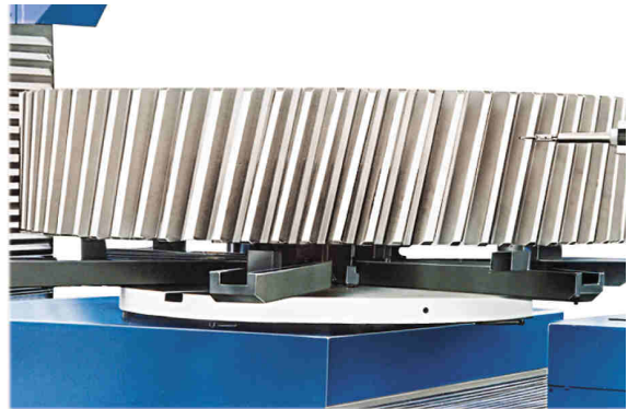
Контроль крупногабаритного зубчатого колеса
